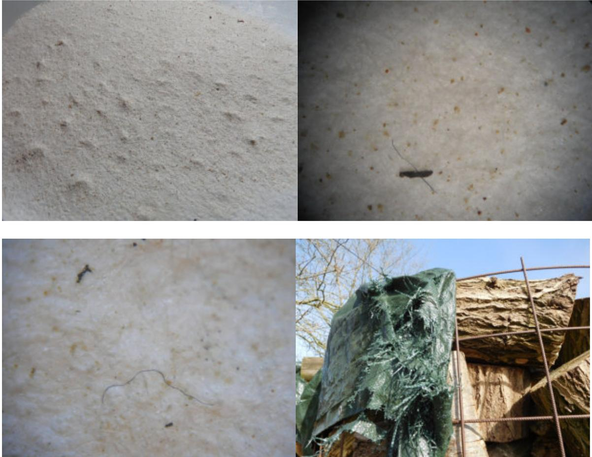
**Feststoffe auf Filterpapier, durch das Salzlösung aus Fleur de Sel geflossen ist; Das Foto unten rechts zeigt an einem Beispiel, wie durch Verwendung von Kunststoffprodukten, hier eine Kunststoffplane, Mikroplastik entsteht**
