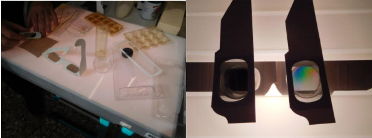
**Leuchttisch und verschiedene Materialien zur Untersuchung von Kunststoff im polarisierten Licht (links) sowie Glaspetrischale und Plastikpetrischale jeweils über einem Polfilter und darüber jeweils mit einem weiteren Polfilter (Vier Polfilter lassen sich aus zwei in der Mitte zerschnittenen Polfilterbrillen herstellen)**
