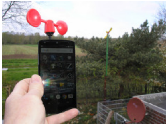
Smartphone als Anemometer
