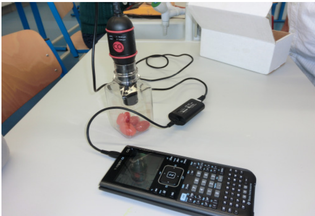
Messungen zu Fotosynthese und Atmung mittels Kohlenstoffdioxidssensor und Taschenrechner
