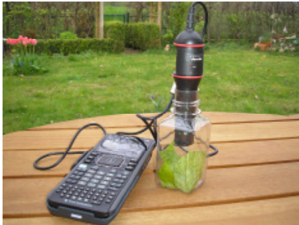
Messung des Kohlenstoffdioxidverbrauchs durch Fotosynthese links (Torfmoss oder Buchenblätter) und der Kohlenstoffdioxidproduktion (Garten- oder Waldboden; Kompost); alternativ mit CO 2 -Monitor und USB-Powerbank
