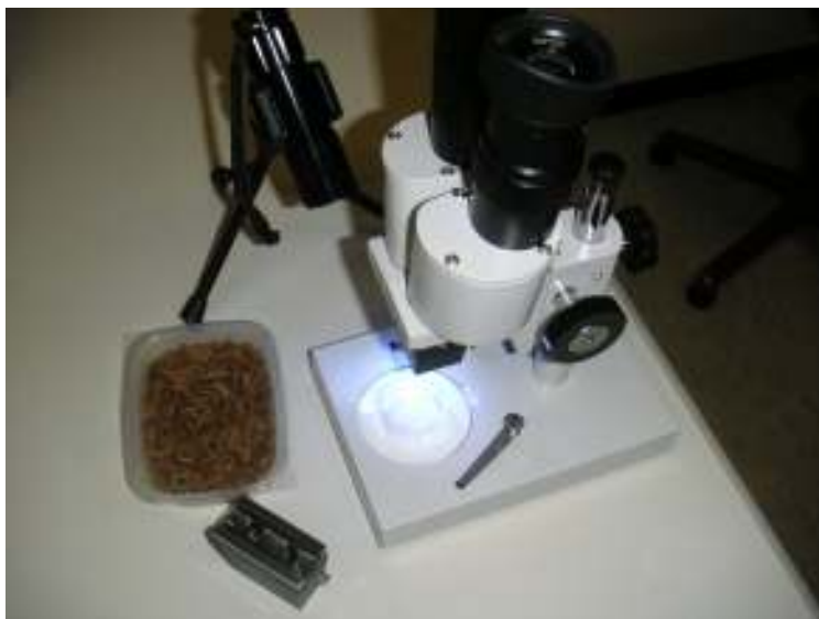
links: Preiswerte Stereolupe mit LED-Taschenlampe am Stativ oder mit Paketband an Halterung befestigt als Beleuchtung (preiswerteste Lösung, max. 100 Euro); rechts oben Stereolupe mit Schrägeinblick, Auf- und Durchlichtbeleuchtung mit Akkubetrieb und Vergrößerung 10- und 30-fach (optimales Preis-Leistungsverhältnis, ca. 200 Euro); rechts unten ältere hochwertige Stereolupe mit Trinokularaufsatz, Zoomoptik mit 7- bis 40-facher Vergrößerung und Beleuchtung mit moderner LED-Schreibtischlampe.
