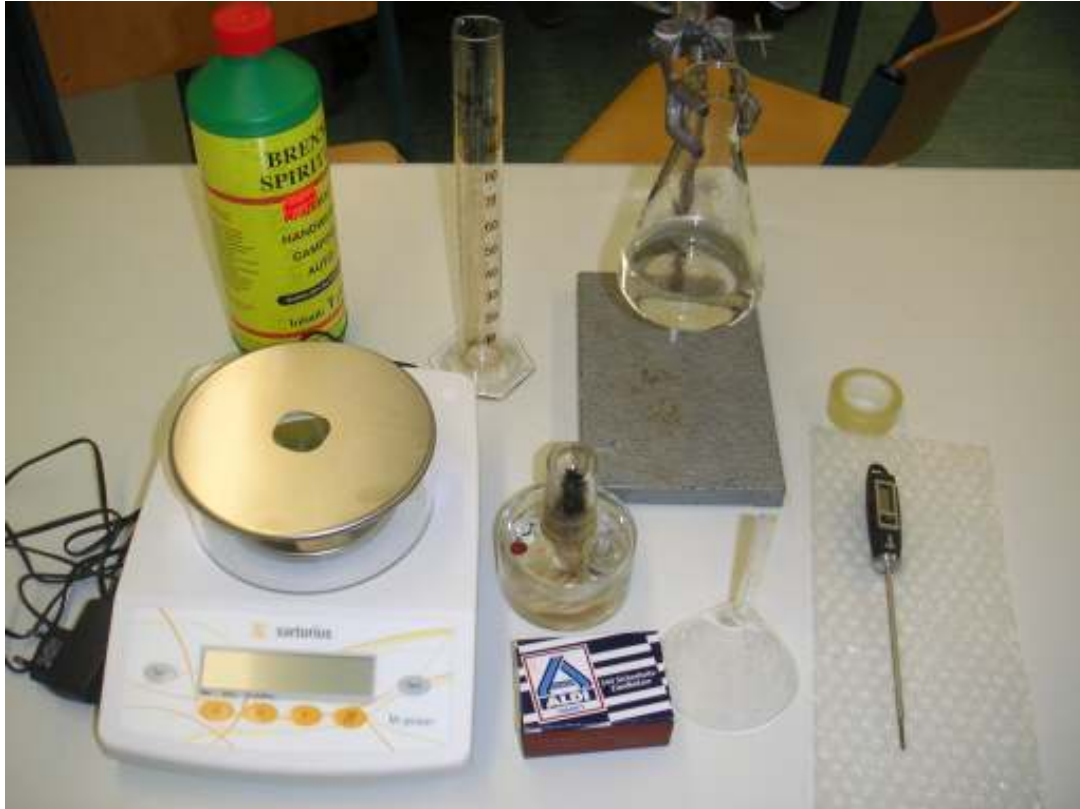
Versuch zur Bestimmung des Energiegehaltes flüssiger Brennstoffe
