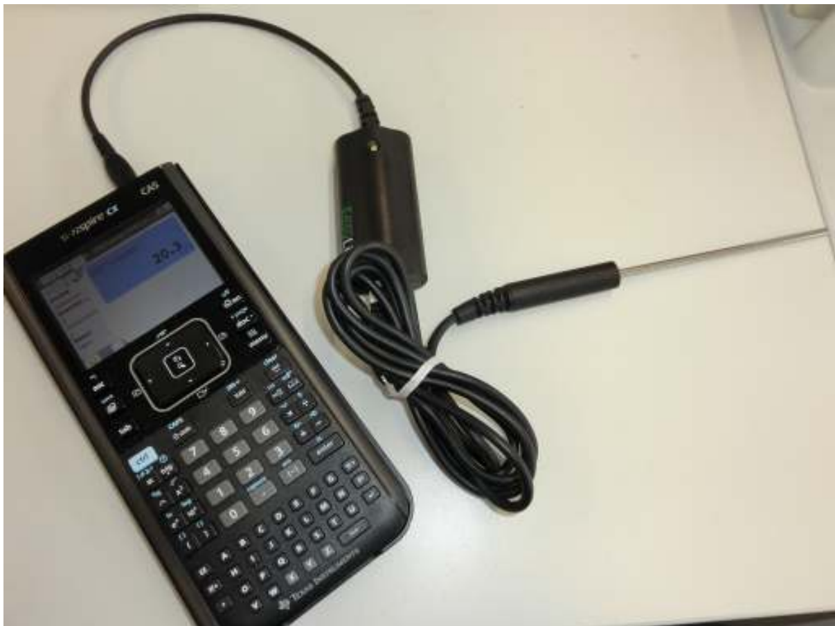
Taschenrechner Texas Instruments Nspire CX mit Messwandler Easylink und Temperaturfühler von Vernier
