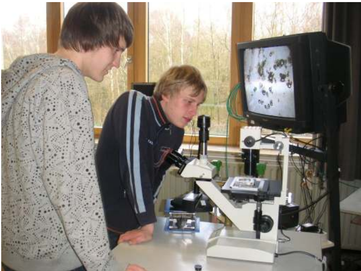
Mikroprojektion mit Mikroskop, Flexkamera und Fernseher
