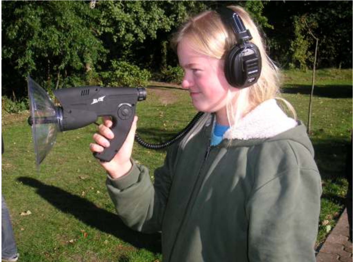
Parabol-Richtmikrofon zur Erfassung von Tierstimmen in der Ferne
