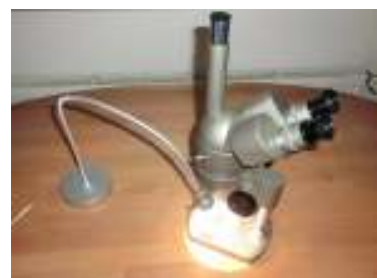
links: Preiswerte Stereolupe mit LED-Taschenlampe am Stativ oder mit Paketband an Halterung befestigt als Beleuchtung (preiswerteste Lösung, max. 100 Euro); rechts oben Stereolupe mit Schrägeinblick, Auf- und Durchlichtbeleuchtung mit Akkubetrieb und Vergrößerung 10- und 30-fach (optimales Preis-Leistungsverhältnis, ca. 200 Euro); rechts unten ältere hochwertige Stereolupe mit Trinokularaufsatz, Zoomoptik mit 7- bis 40-facher Vergrößerung und Beleuchtung mit moderner LED-Schreibtischlampe.
